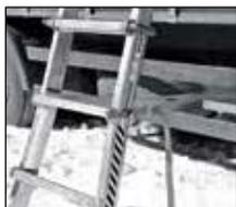
Leiter wird über Gurt am Fahrzeug befestigt. Reflektoren sorgen für gute Sichtbarkeit.
